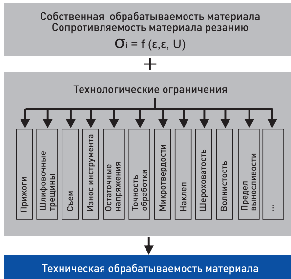
Рис. 1. Схема формирования технологической обрабатываемости материалов в процессах абразивной обработки
