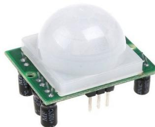
Рис.4 – Датчик движения
