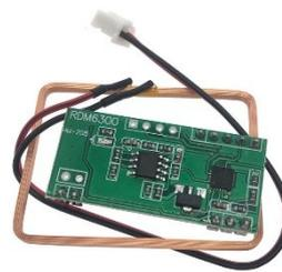
Рис.6 – Считыватель RFID
